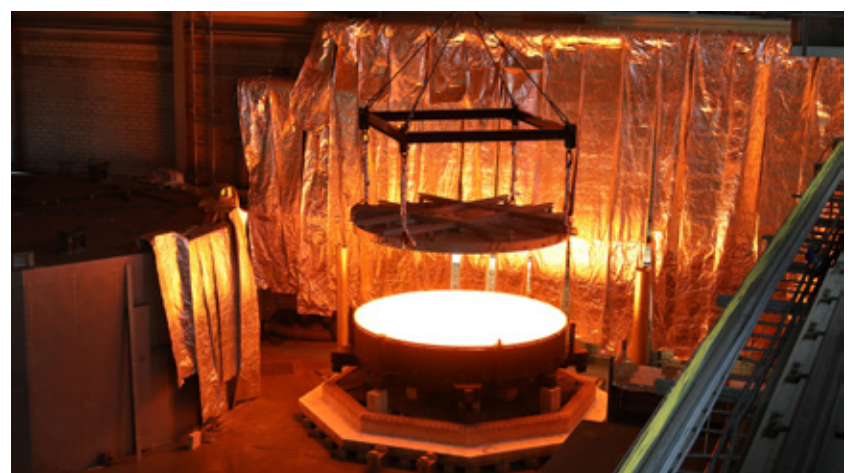
El carbonato de litio es utilizado en la confección de los espejos para proporcionarles la expansión térmica cero, pudiendo soportar las oscilaciones de temperaturas del desierto de Atacama.
