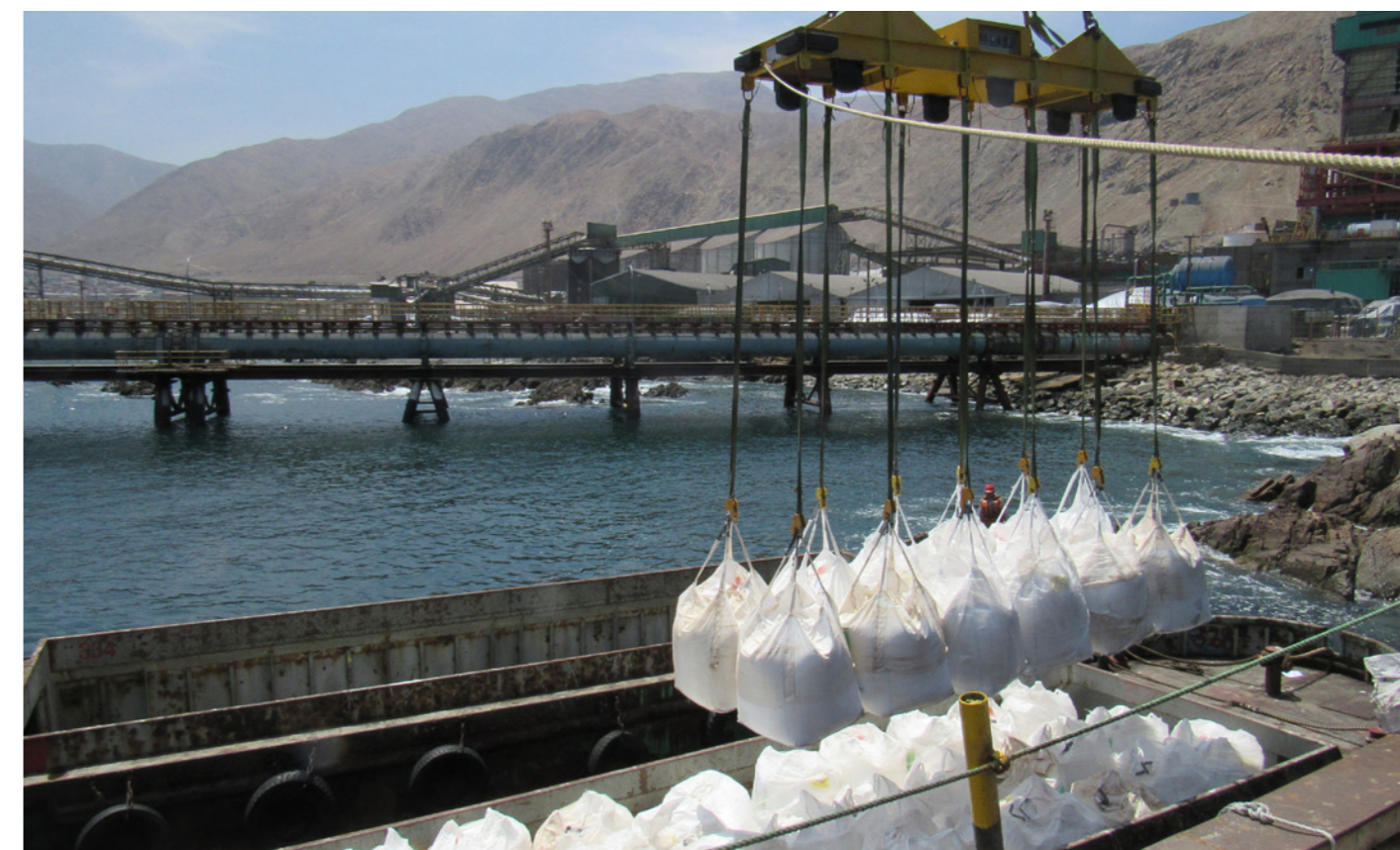
La grúa carga los sacos de nitratos sobre los “faluchos” (embarcaciones intermedias) que los trasladan desde el muelle hasta los grandes barcos para luego iniciar el viaje final con destino a uno de los cinco continentes.
