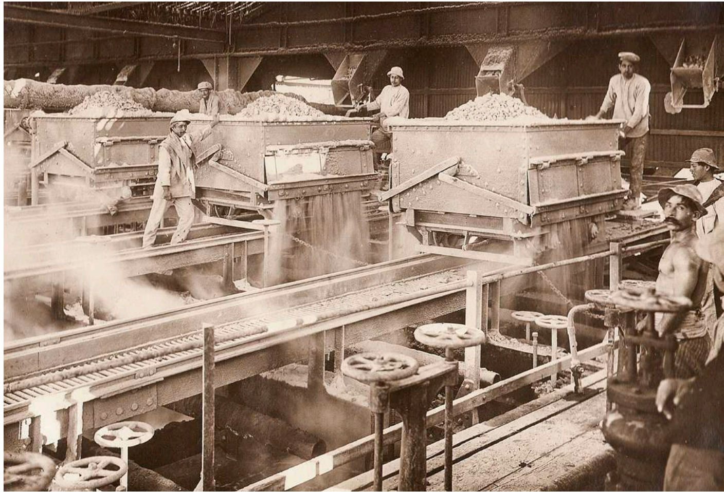
< Proceso de vaciado de los cachuchos en una oficina salitrera. Aproximadamente 1918. Process of emptying the cachuchos in a nitrate Oficina, Approximately 1918.
