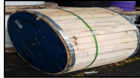
Incorrecta forma de paletizado (sin paletizar)
