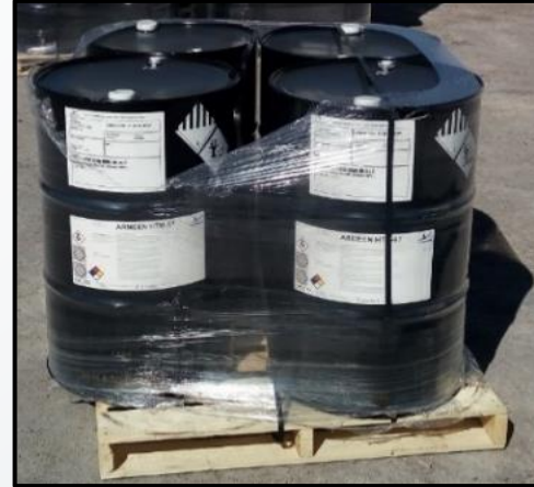
Incorrecta forma de paletizado (carga fuera del pallet)
